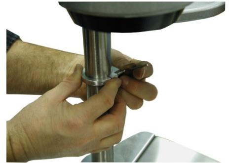
Schieben Sie nun den Auflagering in die gewünschte Position und fixieren diesen wieder. Der Auflagering muss so angebracht werden, dass das obere Abstellbord direkt unter der Öffnung des Lesekopfs am Anschlag ist.
