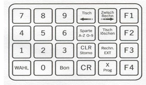
Mit den Tasten „**F2**“ bis „**F4**“ können Sie sich für die weiteren Mengen die Stückzahlen anzeigen lassen.
