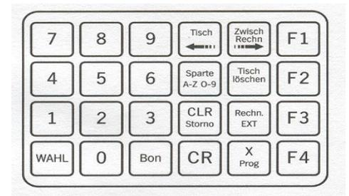
Mit den Tasten „**F2**“ bis „**F4**“ können Sie sich für die weiteren Mengen die Stückzahlen anzeigen lassen.
