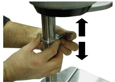
Setzen Sie nun das Ablagebord wieder mit der Führung auf den Ring.
