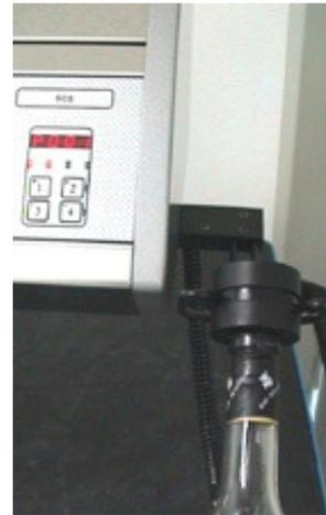
Die Bestätigung, dass der Pourer akzeptiert und programmiert wurde, wird durch das Aufleuchten der zweiten roten LED von links angezeigt
