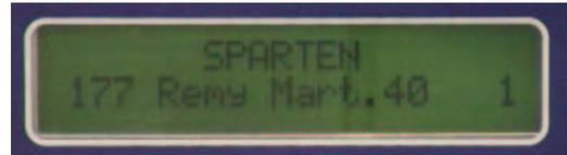
Durch das Einführen des gewünschten Pourers in den Aktivationsring und Drücken der Taste (Menge) **“1”** oder **“2”** wird der zugewiesene Pourer (Artikel) für die Zuweisung automatisch aufgerufen
