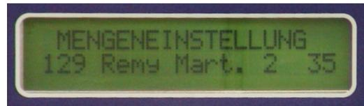
Durch das Einführen des gewünschten Pourers in den Aktivationsring und Drücken der Taste (Menge) “1” oder “2” wird der zugewiesene Pourer (Artikel) für die Zuweisung automatisch aufgerufen
